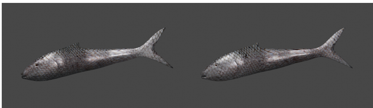
Figur 4.8: En modell av en fisk som har texturerats utan korrekt UV-unwrapping till vänster som då har synliga artefakter, speciellt kring nosen. Till höger är samma fisk men med korrekt UV-mappning. Bilden är ett utsnitt ur arbetsytan i Blender.
